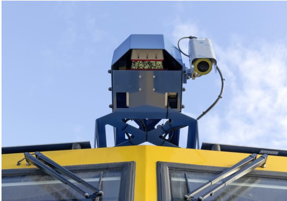
Der TampingAssistant-KI im Einsatz: Die Arbeitsaggregate werden automatisch positioniert, Objekte und Einbauten im Gleis werden zuverlässig erkannt (Bild: Plasser & Theurer).
