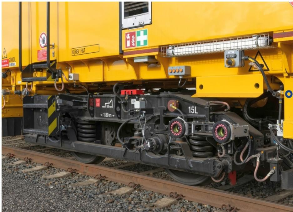
Unverzichtbar für automatisierte Gleisgeometrievermessung: Kombipack der Systeme InertialTrackGeometry und ReferencedTrackGeometry (Bild: Plasser & Theurer).
